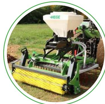
Regarnissage des surfaces avec le **kit semoir**. La semence est soufflée de manière homogène entre les dents. Puis le **kit rouleau** plombe la surface.
