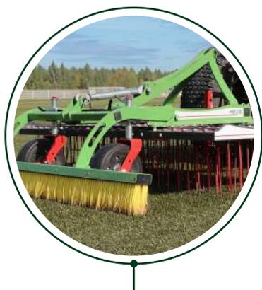
Décompactage/brossage réalisé à grande vitesse : seulement 30 à 45 min pour un passage sur un terrain de 8 000 m<sup>2</sup>.
